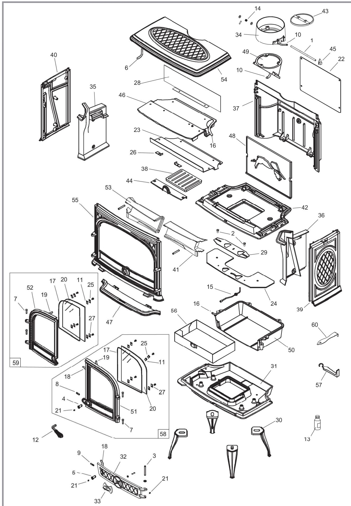
Figuur 7 - Overzicht onderdelen van het toestel
