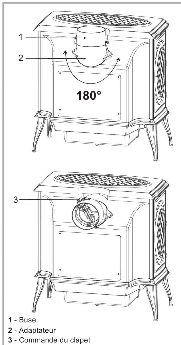
*Figure 3 - Installation de la buse d'évacuation*
